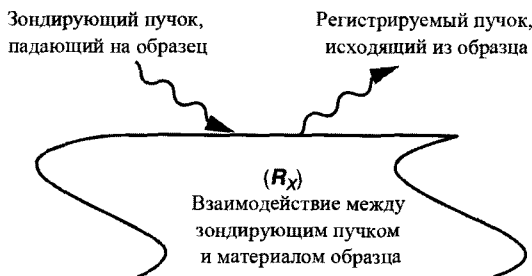
Рис. 1.1. Схематичное представление фундаментальных принципов анализа материалов. Зондирующий пучок частиц или фотонов взаимодействует с образцом. Падающая частица или фотон взаимодействует с материалом образца ( R_x ) и вызывает испускание разнообразных фотонов или частиц, формирующих регистрируемый пучок
