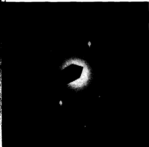
Рис. 8.11. Дифрактограмма выбранной области слоя TiAl (N, O) на подложке из оксида кремния (N.D.Theodore)
