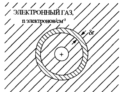
Рис. 6.8. Электронный газ из 4/3\pi r^3 n электронов вокруг положительно заряженного остова испытывает радиальное сжатие \delta r
